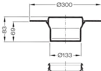
**Aufsatzelement mit Muffe**
